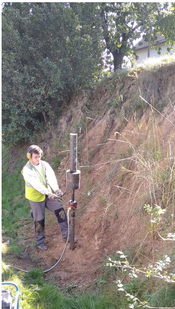
Foto 1: Umístění dynamicky zarážené penetrace ozn. ZS1 (pozn. sonda DPH1 provedena o 15cm vedle)
