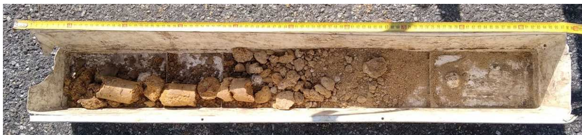
Foto 2: Jádrový výnos z dynamicky zarážené penetrace ZS1
